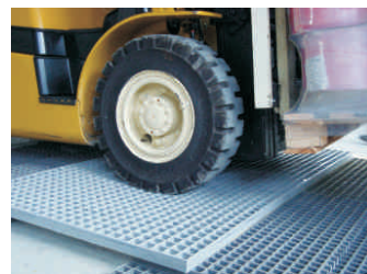
Teste da grade com empilhadeira
